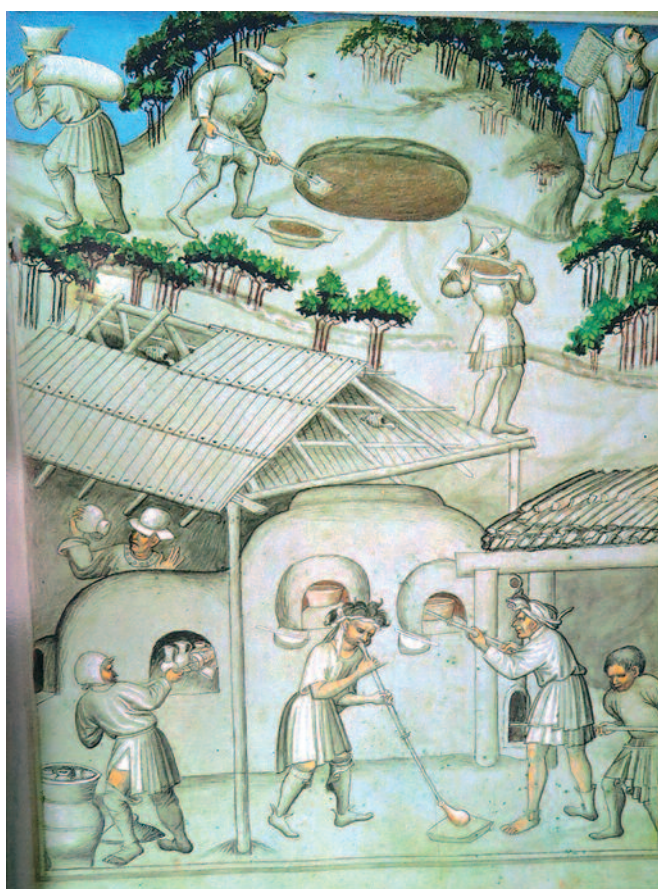
Four de fusion dans une halle de verrerie forestière (opération de soufflage et de recuite). Un maître verrier examine la qualité du verre alors qu'un tiseur apprête le feu du four. À l'arrière-plan, extraction et transport du sable puis distribution à dos d'homme des produits verriers
